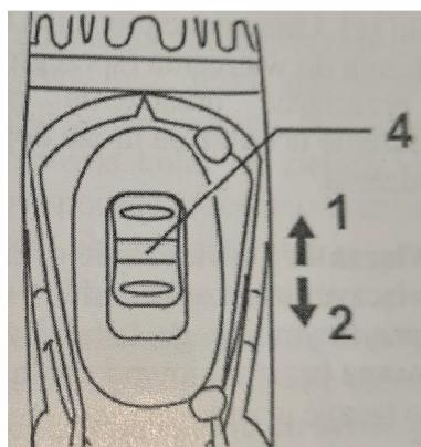
Prepínač smeru otáčania slúži na zmenu smeru otáčania. Prepínač je možné nastaviť v troch polohách: maximálne otáčanie proti smeru hodinkových ručičiek (povoľovanie skrutiek) v smere hodinových ručičiek (vŕtanie, skrulkovanie) a stredná poloha zámok spínača / prepínača.
