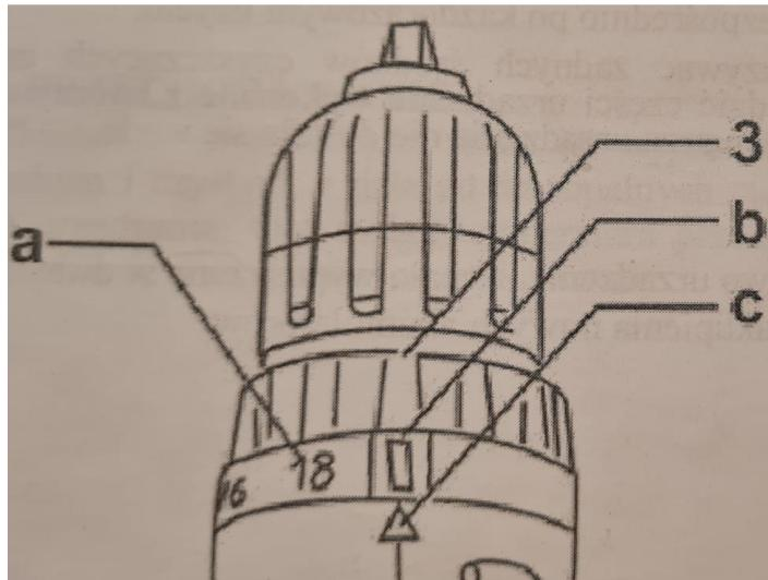
Zariadenie spojky sa používa na nastavenie uťahovacej sily skrutiek, alebo spracovaného materiálu. Pomocou nastavovacieho krúžku spojky (3) môžeme vykonať nastavenie hodnoty 1-16 (1 najnižšia, 16 najvyššia sila tlaku )
